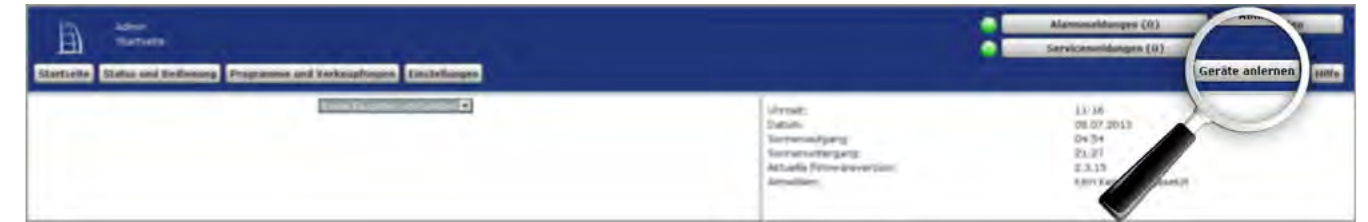
Abbildung 5: Zentrale in den Anlernmodus versetzen
