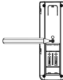
Si le processus d'apprentissage a été correctement effectué, la DEL de l'appareil (**B**) de l'actionneur de commutation sans fil brille d'une lumière verte pendant une seconde. Si l'apprentissage des appareils n'a pas été correctement effectué, la DEL de l'appareil brille d'une lumière rouge pendant deux secondes. Réessayez une fois.
