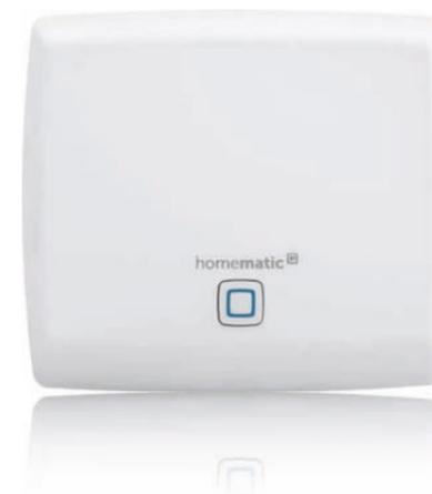
Der Homematic IP Access Point stellt das zentrale Gateway des Homematic IP Smart-Home-Systems dar. Er wird einfach an Ihren herkömmlichen Router angeschlossen und verbindet die in Deutschland befindliche Homematic IP Cloud mit den Homematic IP Geräten im eigenen Zuhause – und das vollständig verschlüsselt. Da Sie bei der Einrichtung nicht nach Ihren persönlichen Daten gefragt werden, bleiben Sie als Nutzer trotz der Verwendung einer Cloud-Lösung anonym.
