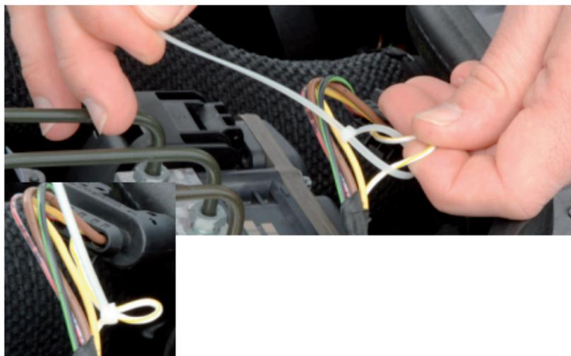
Auch für eine einzelne Windung werden einige Zentimeter Leitungslänge benötigt. Ziehen Sie nicht mit Gewalt an der Leitung. Um die benötigte Länge zu erhalten, muss ggf. ein anderer Einbauort gesucht werden, an dem mehr Leitungslänge zur Verfügung steht.
