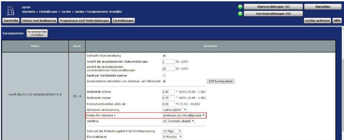
Abbildung 206: Konfiguration Kanalparameter Fußbodenheizungsaktor
