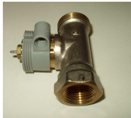
falsch montierter Danfoss RA Adapter
