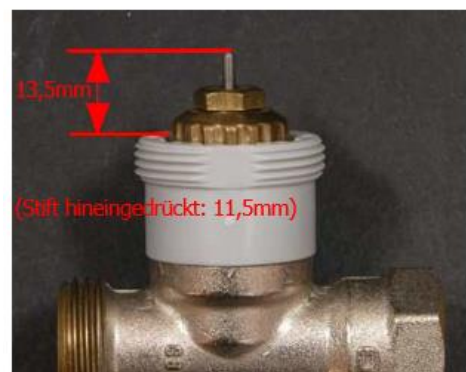
richtig montierter Danfoss RA Adapter
