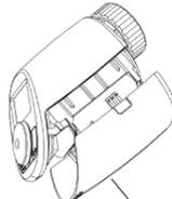
Las pilas alcalinas nuevas tienen una duración de unos 3 años. La visualización de un símbolo de pila en la pantalla señala la necesidad de cambiar las pilas. Después de retirar las pilas descargadas hay que esperar aproximadamente 1 minuto antes de colocar las pilas nuevas. Un funcionamiento con baterías no es posible.
