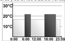
En la pantalla se muestran las barras de cada segundo intervalo temporal de los tiempos programados. En este ejemplo se muestran en la pantalla únicamente las barras para los intervalos de 6:00 a 9:00 horas y de 17:00 a 23:00.
