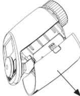
Die Lebensdauer neuer Alkaline Batterien beträgt ca. 2 Jahre. Ein Batteriesymbol (☹) im Display weist darauf hin, dass die Batterien ausgetauscht sind. Nach Entnahme der leeren Batterien sollte bis zum Einlegen der neuen Batterien ca. 1 Minute gewartet werden. Ein Betrieb mit Akkus ist nicht möglich.
