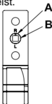
Schieben Sie den Fenstergriff auf den Fenster-Drehgriffkontakt und montieren Sie den Griff wieder am Fenster. Dabei muss der Fenstergriff in waagerechter Stellung stehen!
