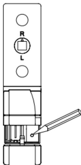
Um den Fenster-Drehgriffkontakt in den Anlernmodus zu bringen, drücken Sie mit einem spitzen Gegenstand auf die Anlerntaste. Die Geräte-LED blinkt orange. (Abbruch durch kurze Betätigung der Anlerntaste, die Geräte-LED leuchtet dann rot auf.)
