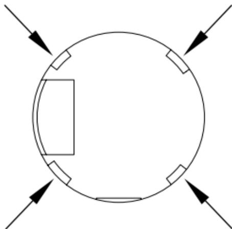
Legen Sie die mitgelieferte Lithium-Batterie (CR 2032) polrichtig entsprechend den Polaritätsmarkierungen in den Batteriehalter (E) ein (Pluspol nach oben).
