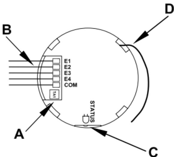
Um die Tasterschnittstelle in den Anlernmodus zu bringen, drücken Sie mit einem spitzen Gegenstand auf die Anlerntaste. Danach befindet sich die Tasterschnittstelle im Konfigurationsmodus, angezeigt durch grünes Blinken der Geräte-LED. (Wollen Sie den Konfigurationsmodus verlassen, drücken Sie kurz nochmals die Anlerntaste.)
