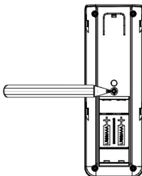
Si le processus d'apprentissage a été correctement effectué, la DEL de l'appareil (**B**) de l'actionneur de commutation sans fil brille d'une lumière verte pendant une seconde. Si l'apprentissage des appareils n'a pas été correctement effectué, la DEL de l'appareil brille d'une lumière rouge pendant deux secondes. Réessayez une fois.
