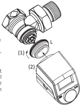
Der Heizkörperthermostat führt eine Adapterfahrt durch. Dabei werden „Ada“ und das Aktivitätssymbol (☒) im Display angezeigt, währenddessen ist keine Bedienung möglich. Die Adapterfahrt kann durch kurzes Drücken des Stellrads abgebrochen werden.
