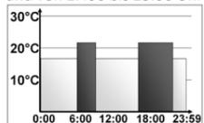
**i** Im Display werden Balken für Zeitschalträume für jedes zweite Zeitintervall angezeigt. Bei diesem Beispiel erscheinen nur für die Intervalle 6:00 bis 9:00 Uhr und 17:00 bis 23:00 Uhr Balken im Display.
