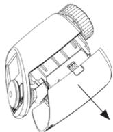
Die Lebensdauer neuer Alkaline Batterien beträgt ca. 3 Jahre. Ein Batteriesymbol (🔋) im Display weist darauf hin, dass die Batterien auszutauschen sind. Nach Entnahme der leeren Batterien sollte bis zum Einlegen der neuen Batterien ca. 1 Minute gewartet werden. Ein Betrieb mit Akkus ist nicht möglich.
